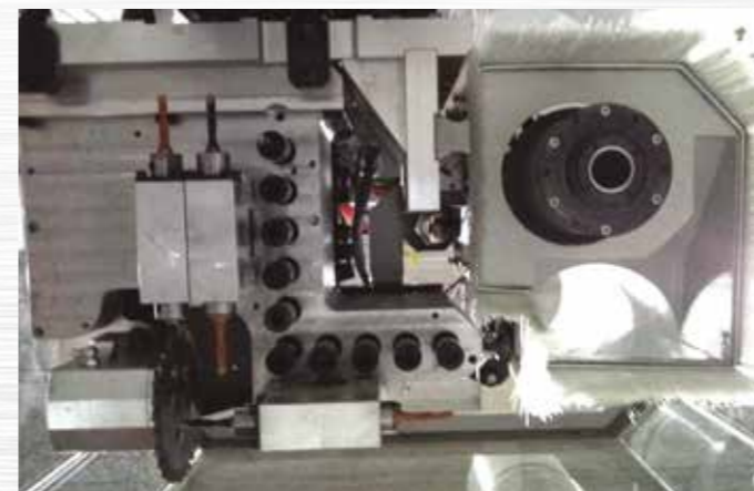
Gruppo a forare con 10 verticali + 6 orizzontali + lama in "X". Drilling unit with 10 vertical + 6 horizontal + saw in "X". Gruppe für Bohrungen mit 10 vertikalen + 6 horizontalen + Klinge auf „X“. Groupe de perçage avec 10 verticales + 6 horizontales + lame en "X". Grupo taladro con 10 verticales + 6 horizontales + sierra en "X".
